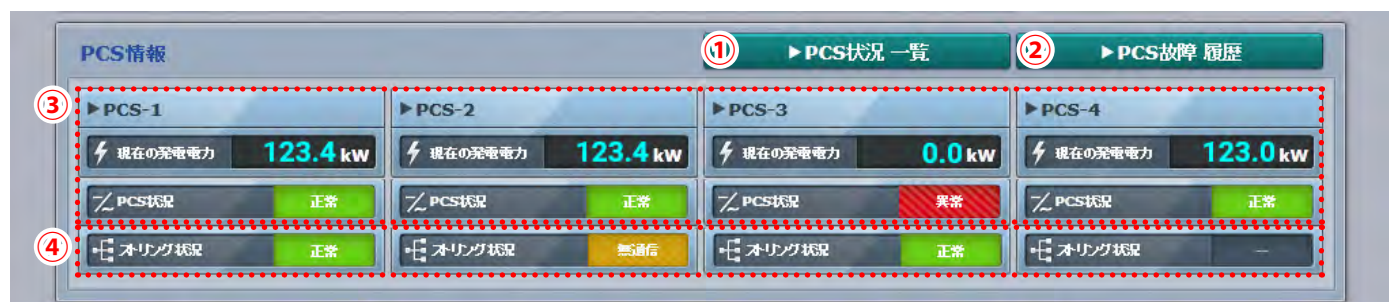
パワーコンディショナとistring計測の画面例
