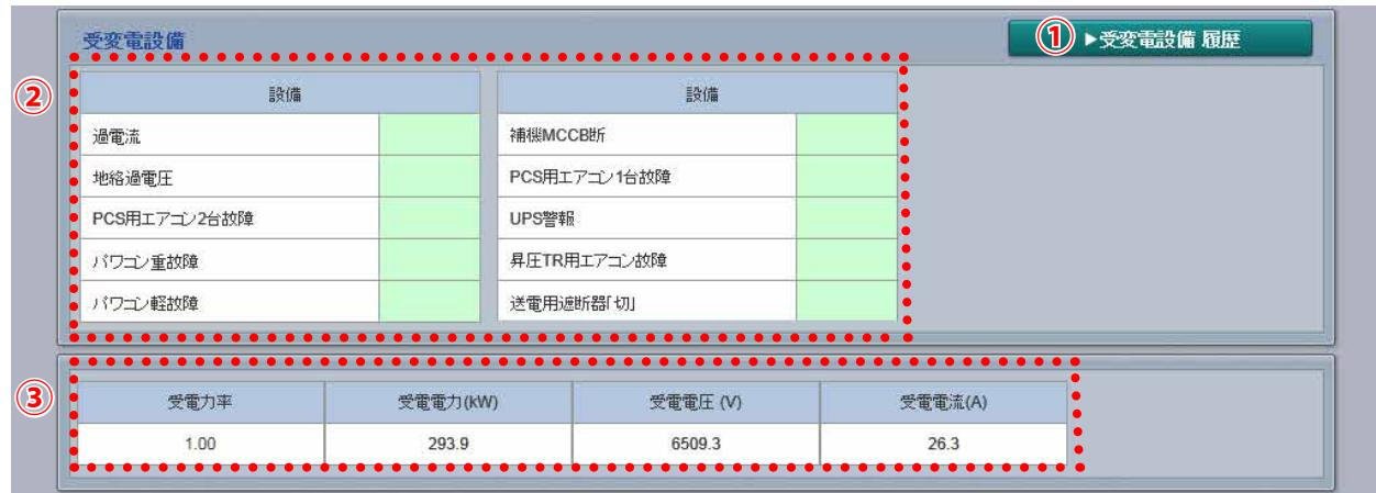
① クリックで受変電設備履歴画面へ遷移します。
