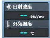
日射計または気温計と、計測端末が通信できていない状態です。
