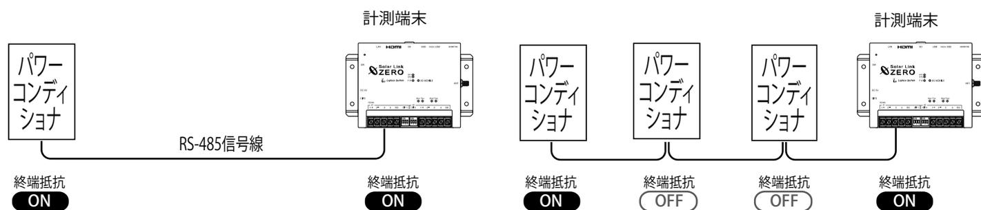
LED 盤の接続や、パワーコンディショナの配置などの理由により、ZERO 本体が RS-485 信号線の終端とならない場合には、終端抵抗を OFF にする必要があります。
